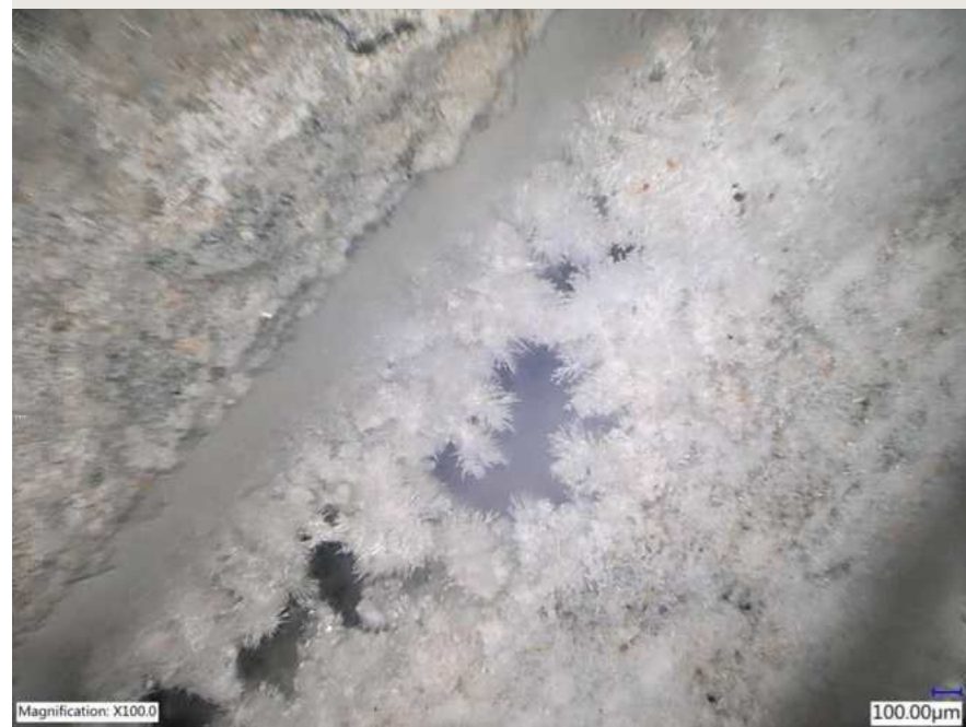
Immagine al microscopio Magnification: X100.0 della cristallizzazione in una fessura del calcestruzzo.
